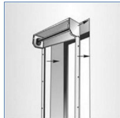
Направляющие шины рольставни должны быть выставлены по уровню в вертикальной плоскости. Изделие должно быть расположено симметрично относительно проема. Допустимы зазоры не более 5 мм. Разница длины диагоналей по крайним точкам направляющих шин не должна быть более 2 мм.
