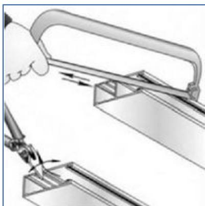
Установить каркас роллеты, предварительно сняв защитную пленку с короба. Во избежание повреждения элементов рольставни патроном, пользоваться удлиненными сверлами или бурами по бетону.
