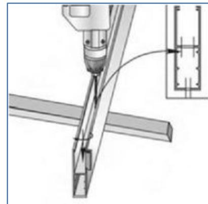
Подготовить отверстия в отбортовках боковых крышек для последующей установки декоративной крышки короба.
